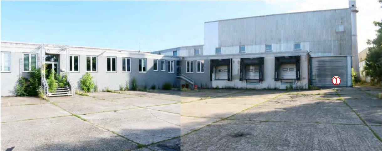
**Foto 5:** Blick von der Hoffläche auf dem Flurstück 116/4 auf das ehem. Werkstattgebäude mit davor liegenden Büroräumen (links) und die ehem. Glashütte (rechts). Hinter dem Rolltor (①) lag auf der Rampe zum Keller die ehem. Mischanlage für die Glasrohstoffe („Gemengehaus“). Foto: M. Grimm 07.07.2021.
