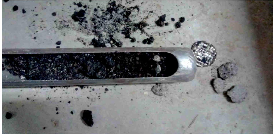
Foto 1: Bohrprofil RKS 16 (aus der ersten Untersuchung) aus dem inneren des ehemaligen Kühlraums zum Vergleich.
