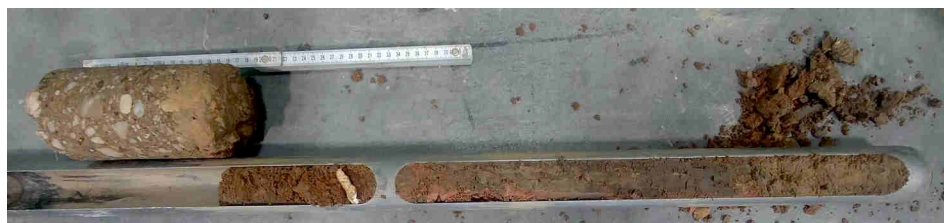
Foto 10: Bohrprofil RKS 23 gemischtkörnige Auffüllungen
