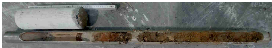
Foto 8: Bohrprofil RKS 22 gemischtkörnige Auffüllungen
