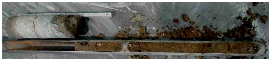
Foto 6: Bohrprofil RKS 21 gemischtkörnige Auffüllungen
