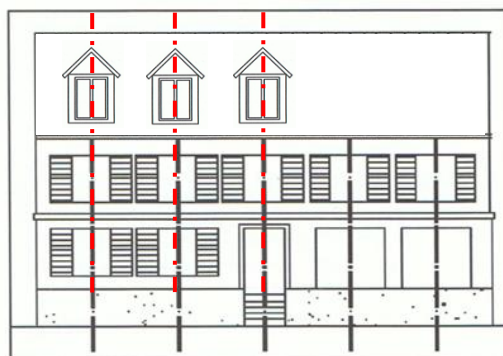
Vertikale Ausrichtung von Gauben auf die Fassadengliederung (Fensterachsen)
