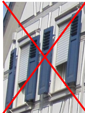
Rollladenkästen sind innenliegend, d.h. nicht vom Straßenraum aus sichtbar, anzubringen
