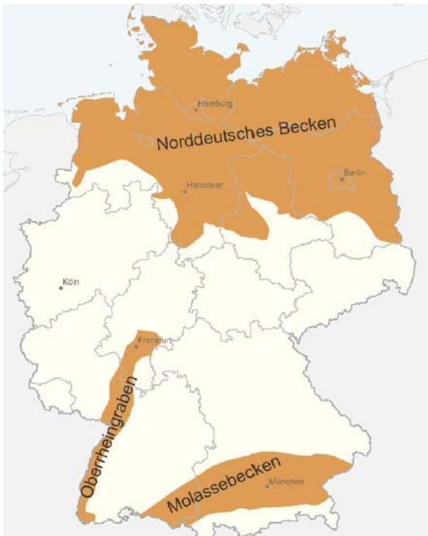
Abbildung 9-9 Potenzielle Zonen in Deutschland für eine hydrogeothermische Nutzung (GeotIS, 2013)
