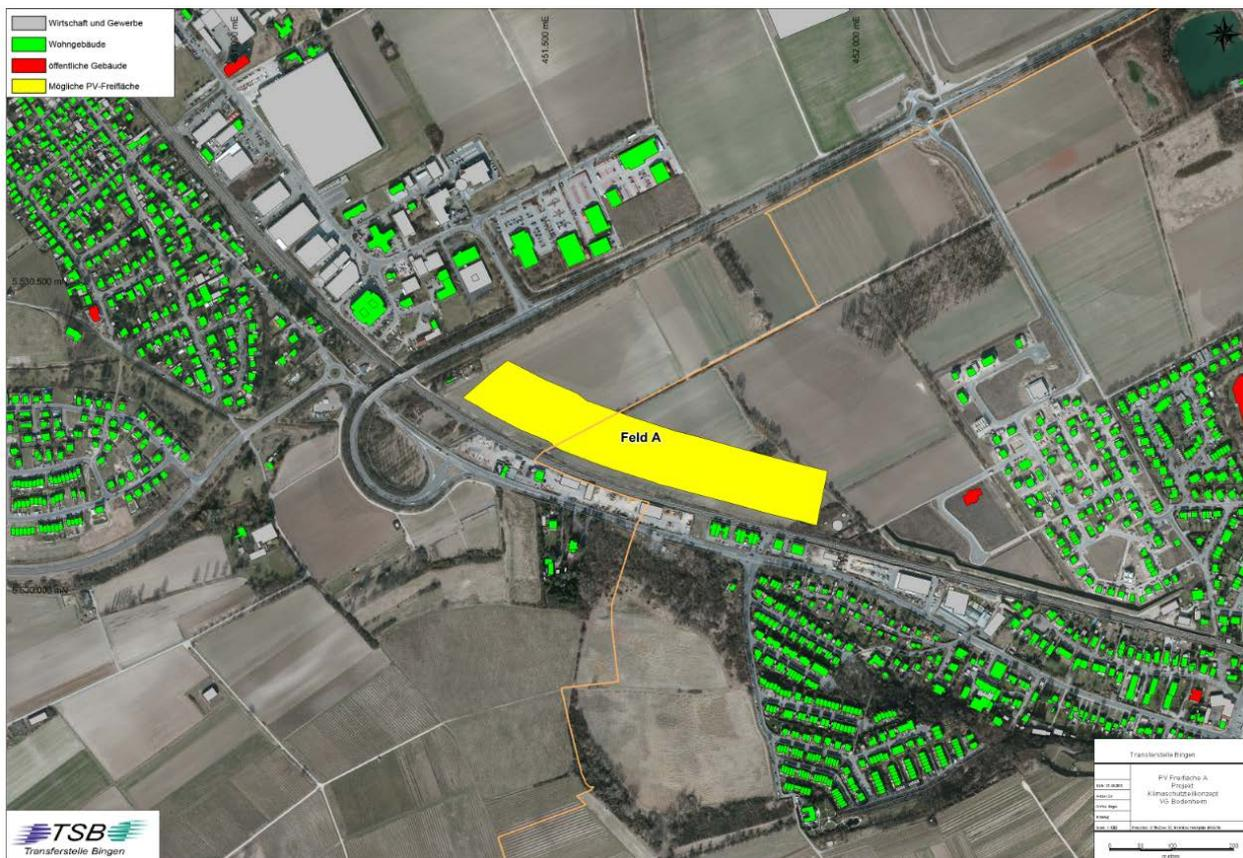
Abbildung 9-4 potenzielle Fläche A für Fotovoltaik-Freiflächenanlage entlang Bahnstrecke (verändert nach Landesamt für Vermessung und Geobasisinformation-Rheinland-Pfalz (LVermGeo-RLP))
